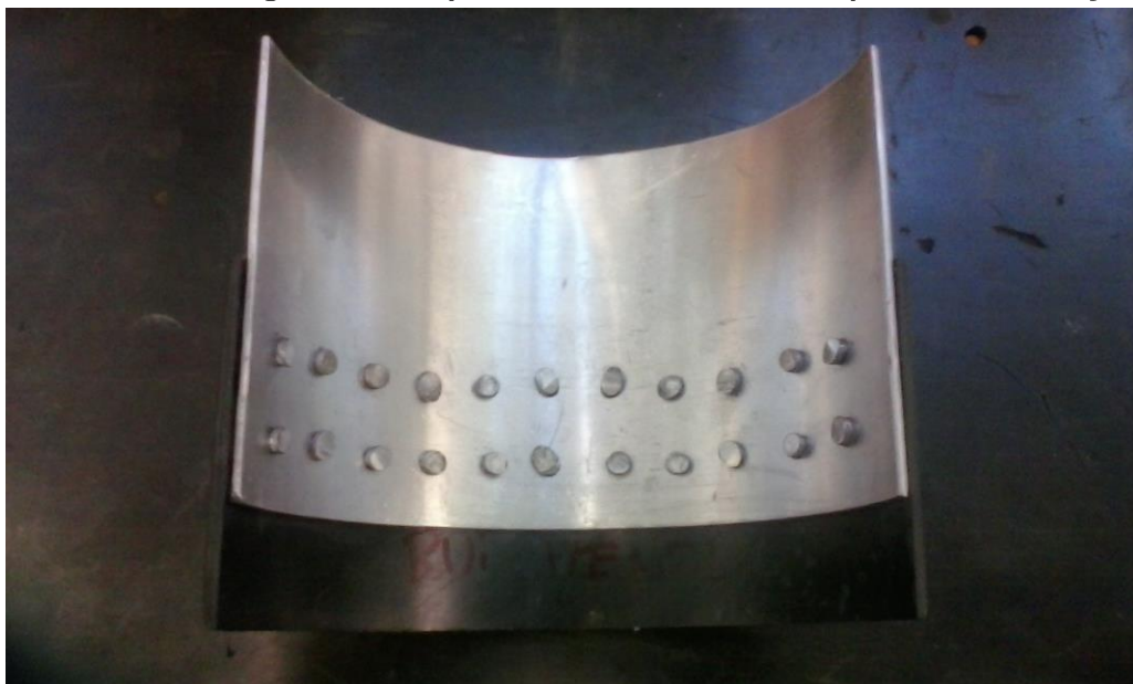
FOTO 2 – Carenagem com Cepos Não Conformes (Exercício Avaliação)
