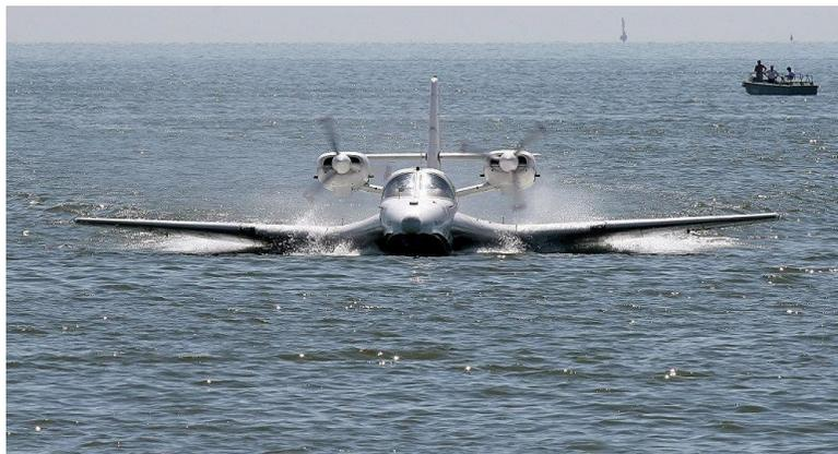
Nas aeronaves aquáticas ou anfíbias. Estas aeronaves. estão aptas a sofrer danos na hélice, causados pelo jato de água levantado pelo casco durante pousos e decolagens da água.
