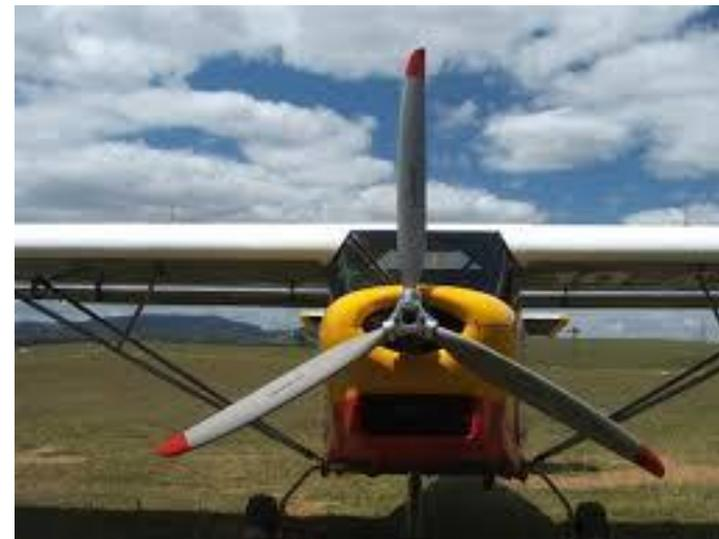
A hélice ajustável no solo é usada em aeronaves de potência, velocidade, alcance e altitudes baixas.
