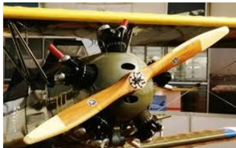
A hélice de passo fixo é usada em aeronaves de potência, velocidade, alcance ou altitude baixa.
