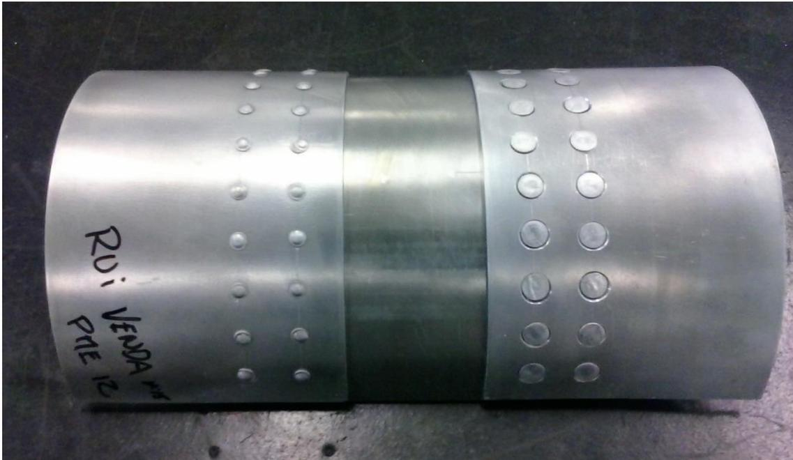
FOTO 1 – Peça em Alumínio, Curvilínea, Rebitada – Vista Frontal “Near”
