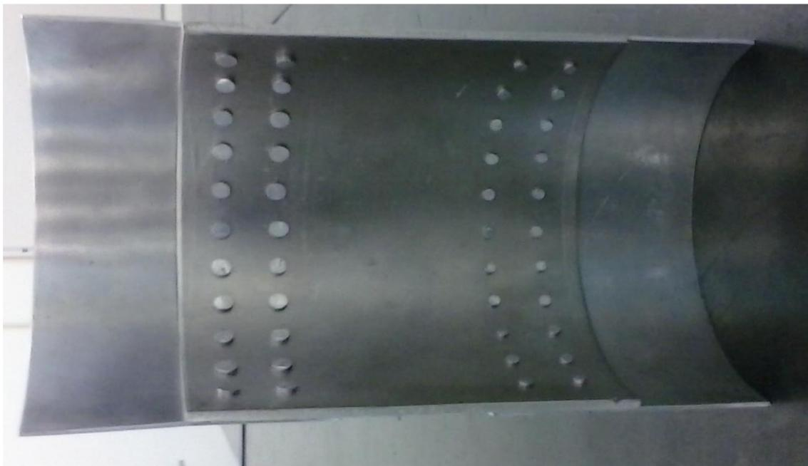
FOTO 2 - Peça em Alumínio, Curvilínea, Rebitada - Vista Posterior “Far”
