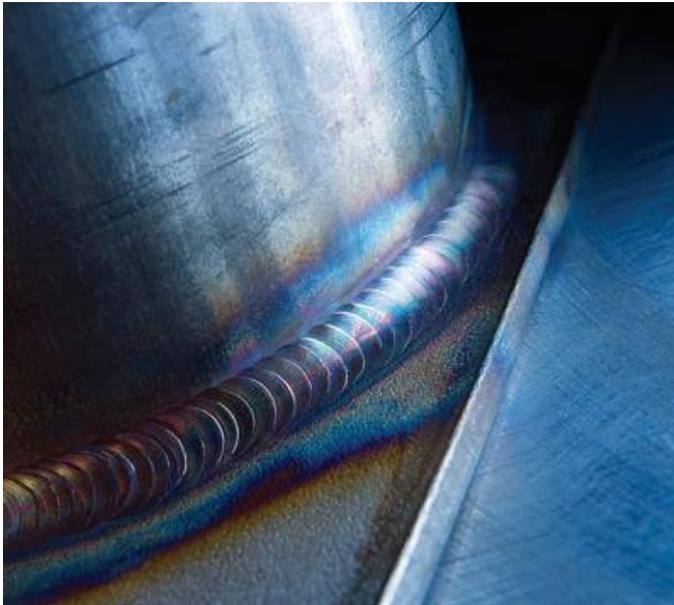
Foto 28 – Soldadura TIG (Tungsten Inert Gas)
