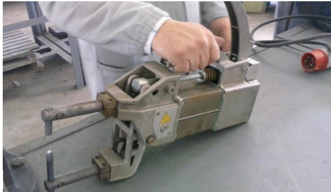
Foto 32 – Soldadura por pontos
