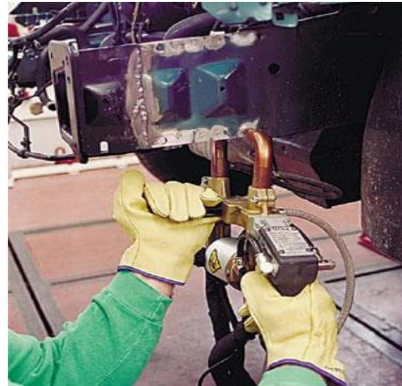
Foto 26 – Soldadura a Resistência
