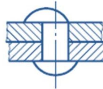
O **comprimento do corpo do rebite** é pequeno em relação à espessura da chapa - Nessa situação, o material disponível para rebitar a segunda cabeça não é suficiente e ela fica incompleta, com uma superfície plana.
