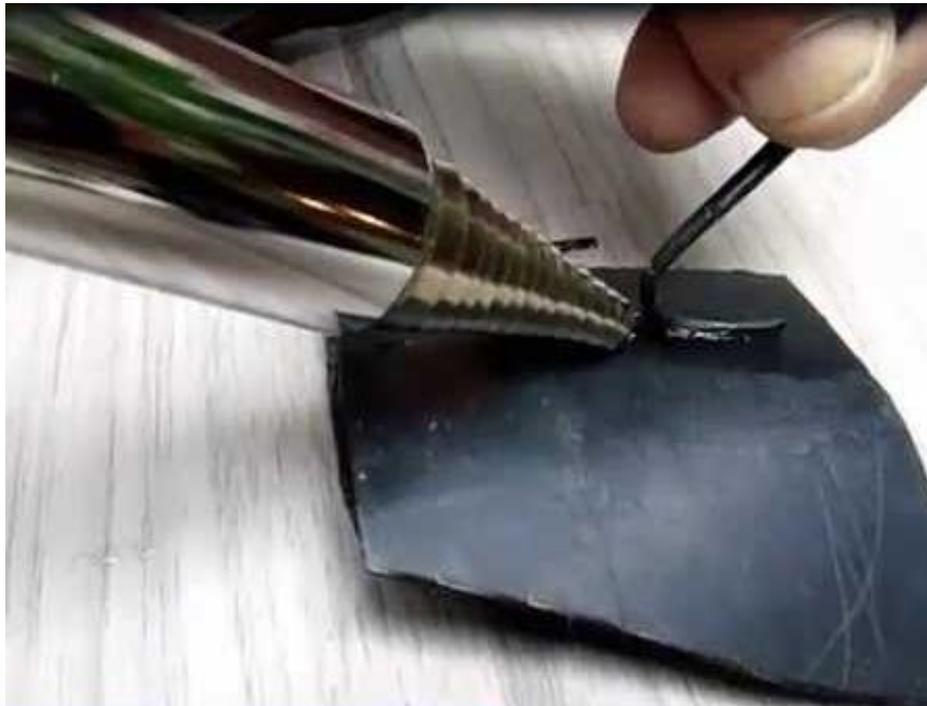
Foto 29 – Soldadura de Materiais Plásticos
