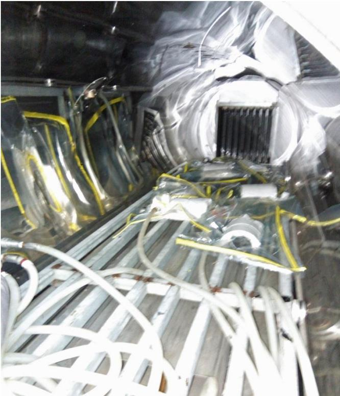
FOTO 40 - Peças Ensacadas no Autoclave
