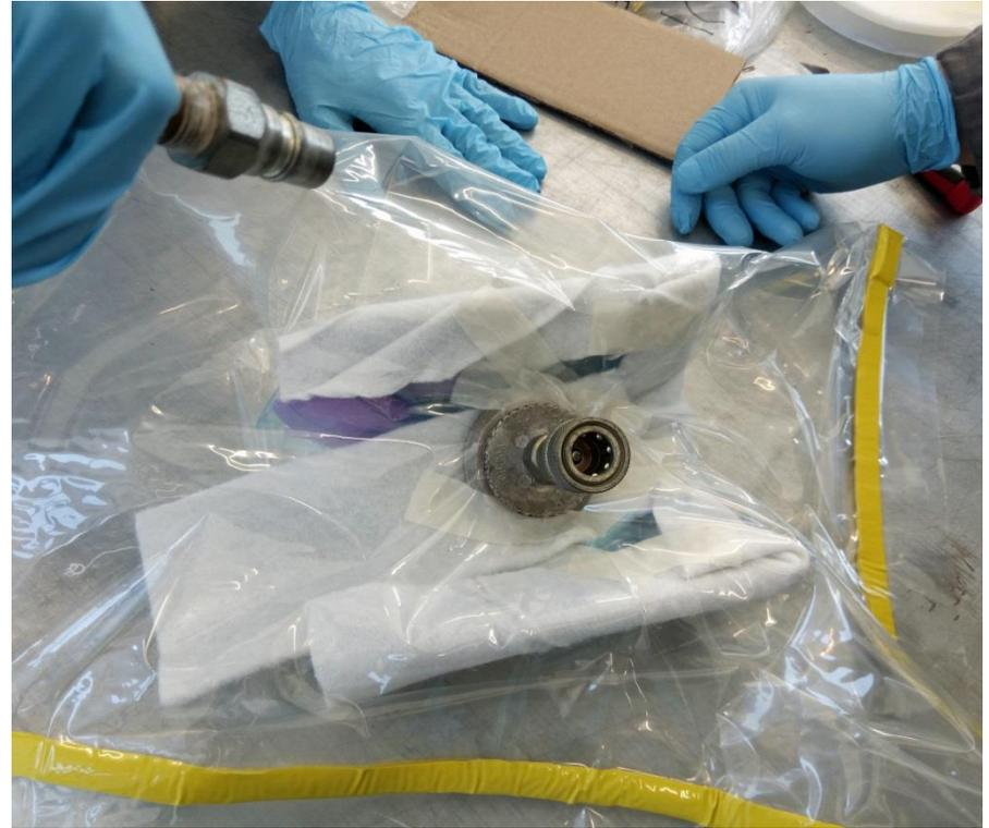
**FOTOS 33 e 34 - Colocação do Bico de Vácuo**
