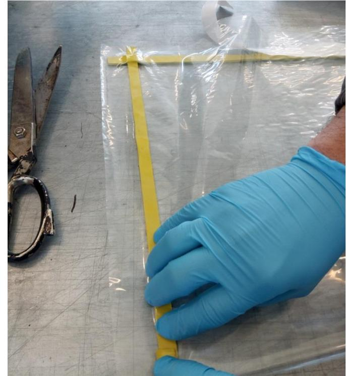
**FOTOS 29 e 30 - Preparação do Ensacamento (Colocação de Bambam)**
