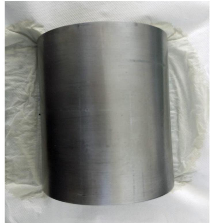
**FOTO 7 - Molde após Aplicação de Desmoldante**
