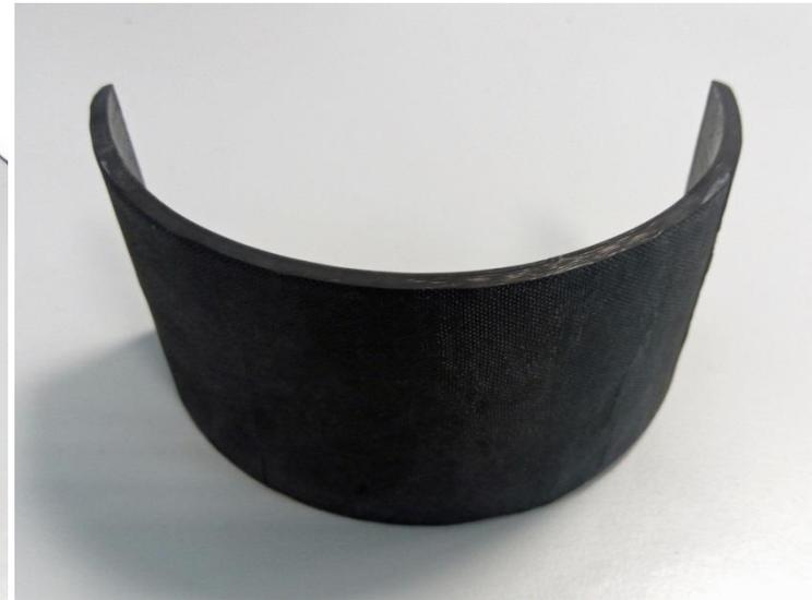
FOTOS 47, 48 e 49 - Peça em Fibra de Carbono Unidireccional e Fibra de Vidro (Resultado Final)
