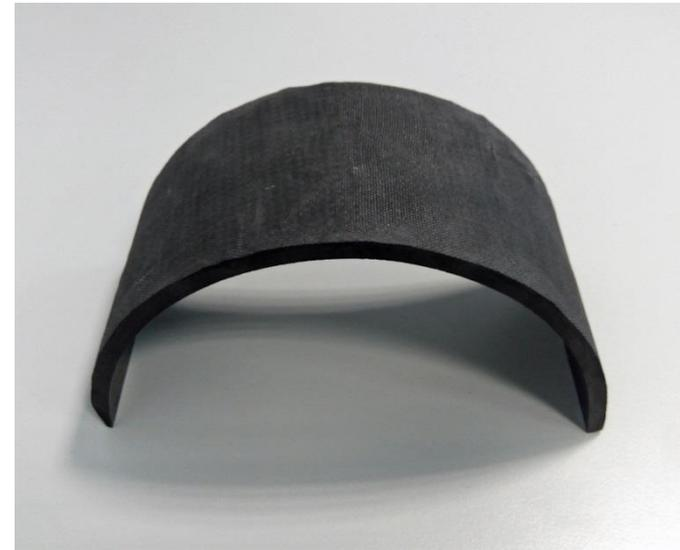
**FOTOS 50, 51 e 52 - Peça em Fibra de Carbono Bidireccional e Fibra de Vidro (Resultado Final)**
