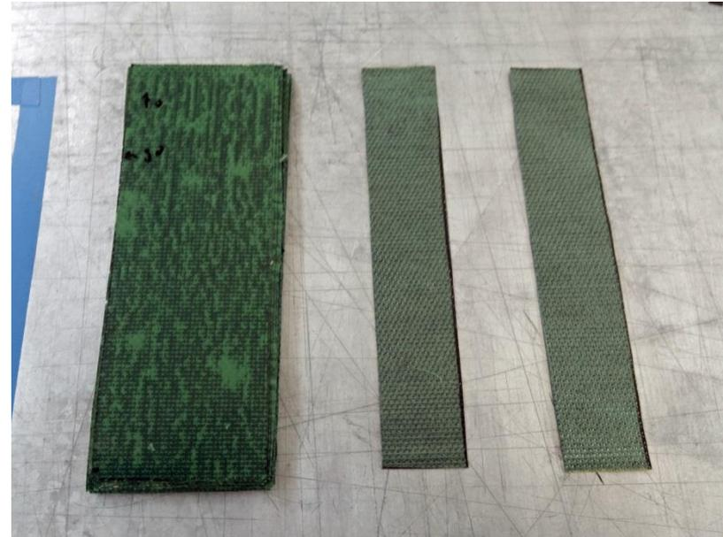
FOTO 17 - Tiras de Tecido de Fibra de Carbono Bidireccional e Fibra de Vidro
