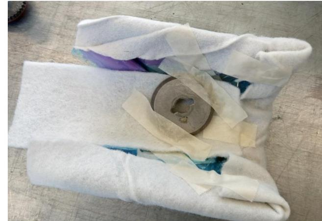
**FOTOS 26, 27 e 28 - Colocação de Manta Drenante e Canalizador**
