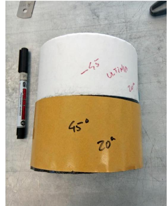
FOTOS 20, 21 e 22 - Tecidos de Fibra de Vidro e de Fibra de Carbono Unidireccional e Bidireccional Laminados
