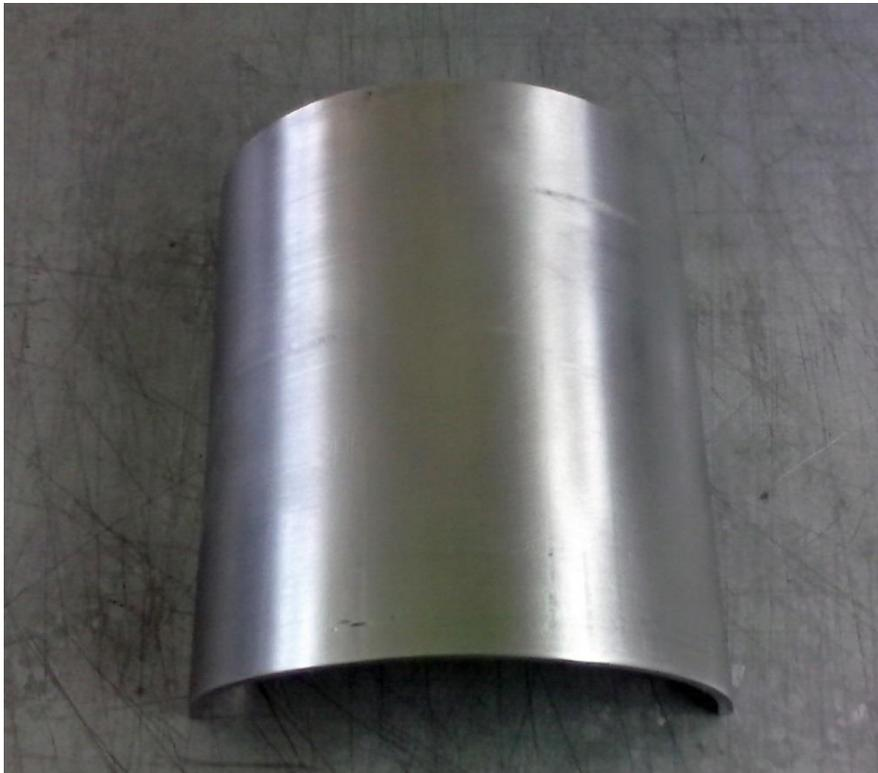
**FOTO 6 - Molde após Preparação (Lixada e Limpa)**
